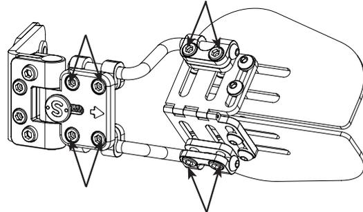
3. Stringere infine i quattro elementi di fissaggio mostrati per impostare la profondità del cuscinetto e fissare l'angolo di curvatura.
