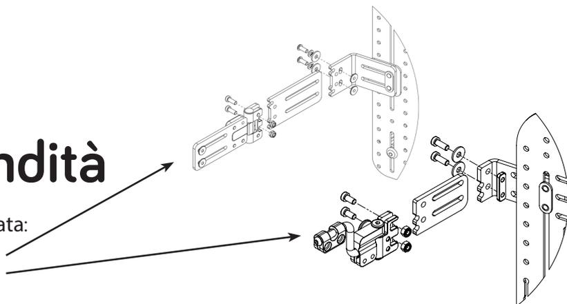
2. Utilizzare la staffa di estensione per regolare la profondità del supporto laterale secondo la necessità. Assicurarsi che gli elementi di fissaggio siano serrati correttamente.
