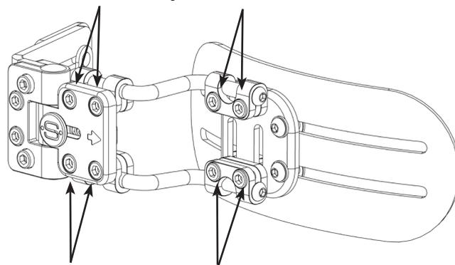
2. Utilizzare una chiave esagonale da 4 mm per regolare la posizione della piastra, regolando i due dispositivi di fissaggio mostrati.
