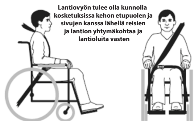
Kuva 3b - Turvavyöt on vedetty ja asetettu oikein pyörätuolissa istuvan päälle.
