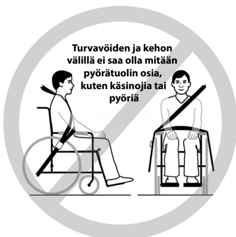
Kuva 3a - Lantiovyö on asetettu väärin pyörätuolin rakenteiden päältä.
