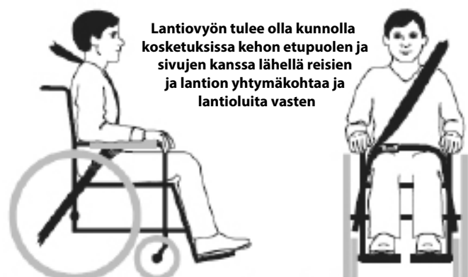
Kuva 3b - Turvavyöt on vedetty ja asetettu oikein pyörätuolissa istuvan päälle.
