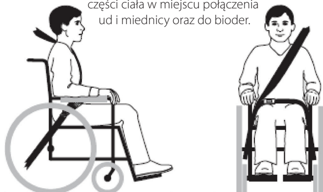
Rysunek 3b – Prawidłowe ułożenie i rozmieszczenie pasów bezpieczeństwa na wózku inwalidzkim.
