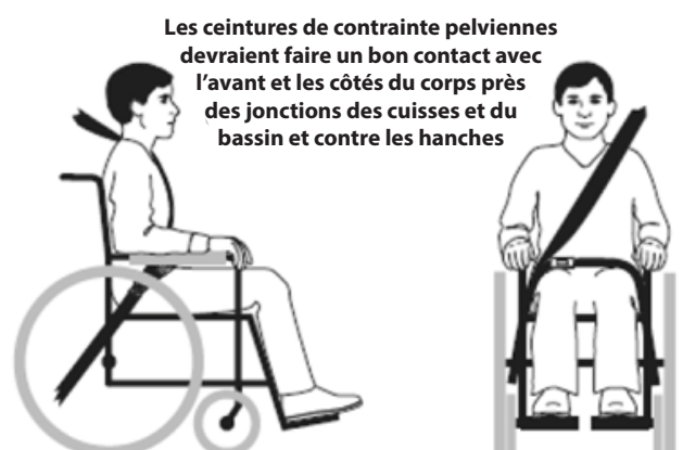
Figure 3b – Acheminement et positionnement corrects des ceintures de contrainte sur l'occupant du fauteuil roulant.
