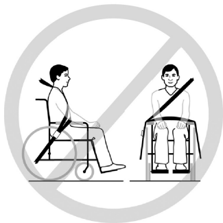
Figura 3a: cinturones de seguridad pélvicos colocados incorrectamente sobre la estructura de la silla de ruedas.
