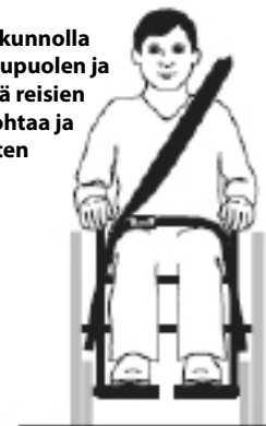
Kuva 3b - Turvavyöt on vedetty ja asetettu oikein pyörätuolissa istuvan päälle.
